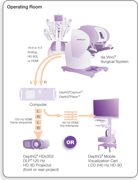
DepthQ<sup>®</sup> Mobile<sup>™</sup> HD 3D Stereoscopic Visualization System Data Flow
