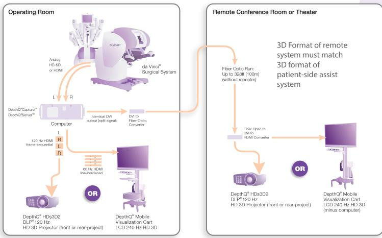
DepthQ<sup>®</sup> Mobile<sup>™</sup> HD 3D Stereoscopic Visualization System Data Flow
